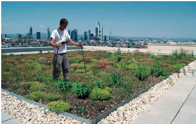
Bild 7. Protectsys B – Leckstellen sofort, punktgenau und kostengünstig finden (Fotos/Grafiken 2, 3, 5–7: ILD Deutschland GmbH)
